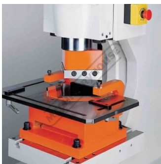
Optional Vee Notcher Punch Side
