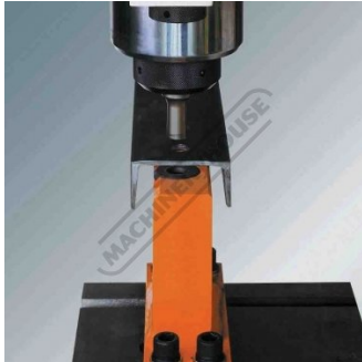
Optional Channel Punching Die Holder
