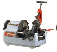
Pipe Threading Machine -Automatic Die Head
